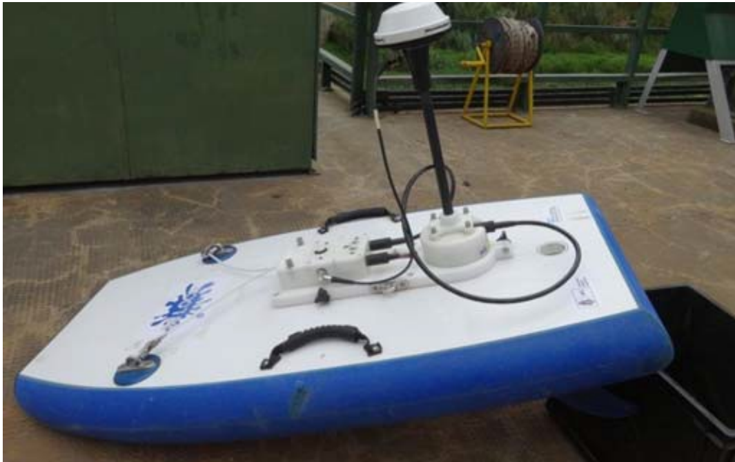
Figura 2.- ADCP y demás dispositivos montados en la plataforma móvil de medición.
