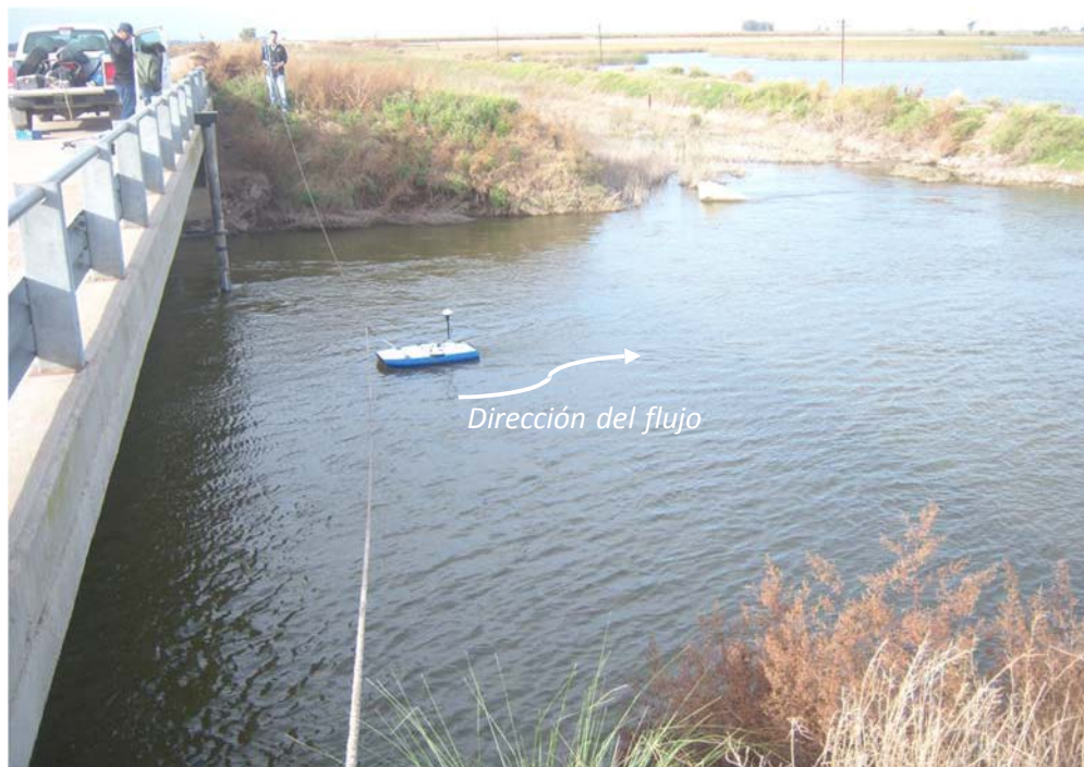
Figura 11.- Sección de aforo sobre el río Quinto en el puente Onagoity.
