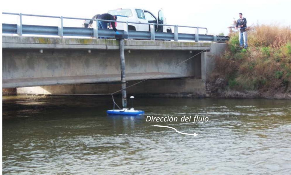
Figura 12.- Sección de aforo sobre el río Quinto en el puente Onagoity.
