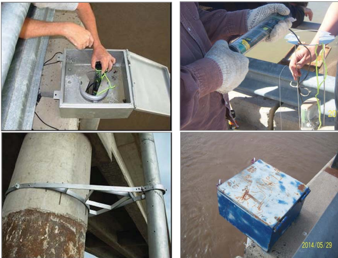
Figura 2: Receptáculo del instrumental y soporte en pila de puente
