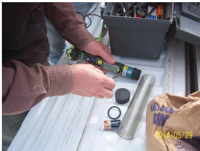
Figura 17: Thalimedes que se extrajo en el Puente Carretero sobre Canal Devoto
