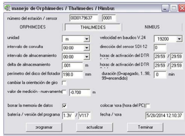
Figura 6: Calibración de Thalimedes instalado en la sección del puente carretero sobre el Río IV.
